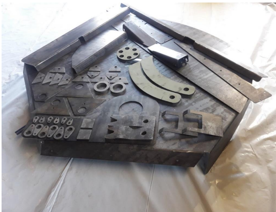
KUVA 25. Särmätyt osat ja polttoleikkeitä (Tolvanen 2018.)
