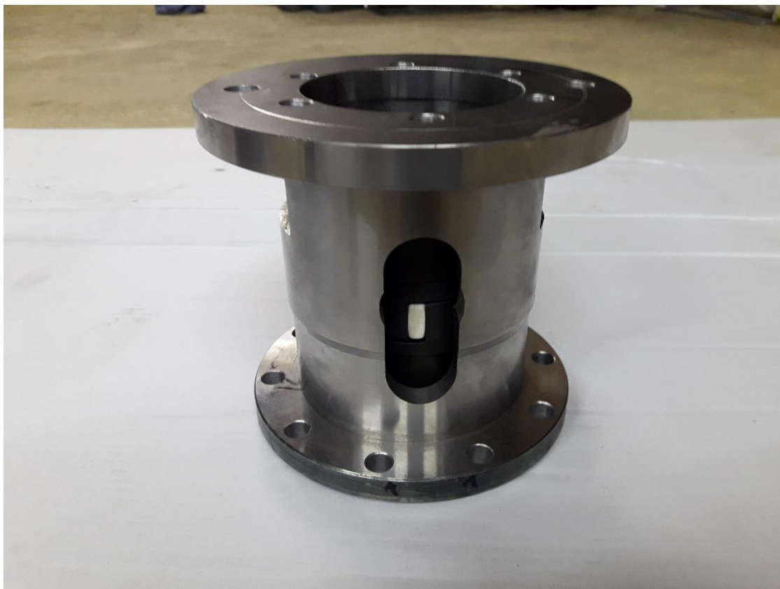
KUVA 21. Hydraulimoottorin kiinnitysputki (Tolvanen 2018.)
