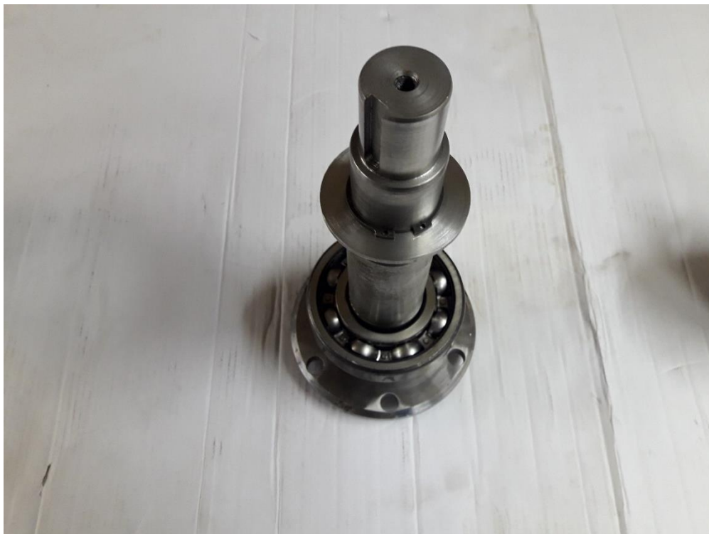
KUVA 16. Pääakseli varustettuna teräkiekon kiinnityslaipalla, laakerilla ja lukkorenkaalla (Tolvanen 2018.)
