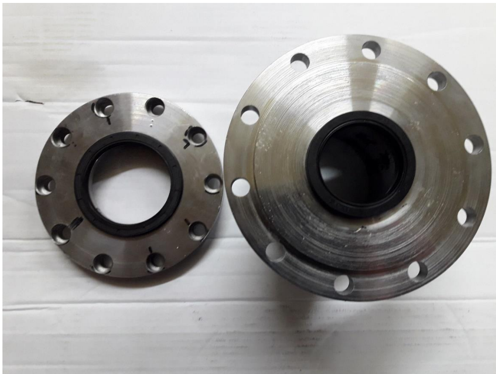
KUVA 18. Ainesputken kannet varustettuna akselitiivisteillä (Tolvanen 2018.)
