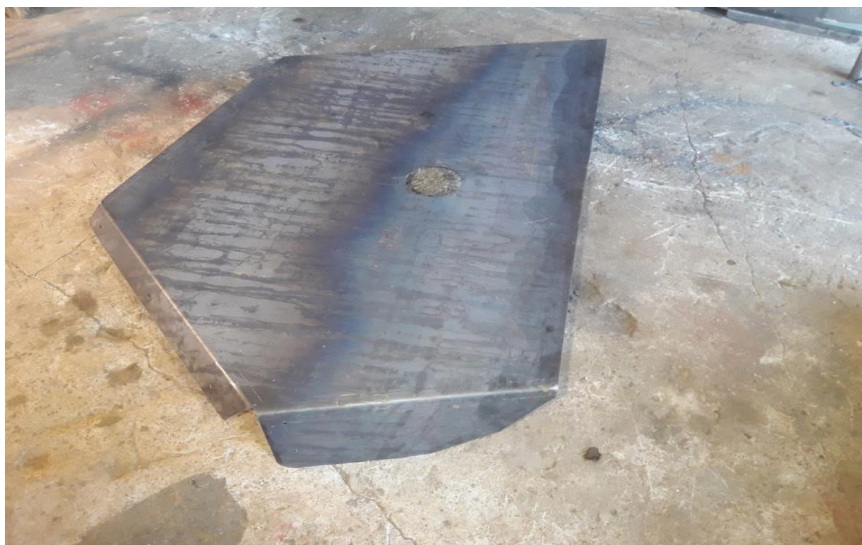
KUVA 14. Runko särmättynä (Tolvanen 2018.)
