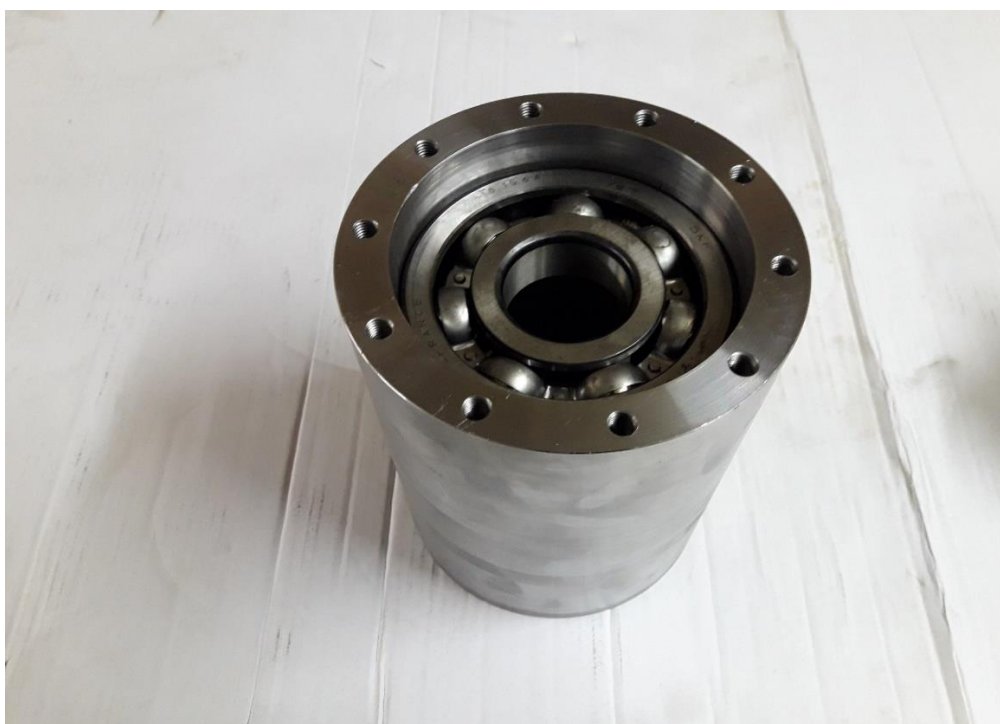
KUVA 17. Koneistettu ainesputki laakerilla (Tolvanen 2018.)
