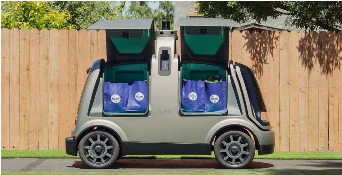
Kuva 6. Nuron älyauto, jossa erilliset ostoksille tarkoitetut tilat. Tilaa matkustajille ei ole (Silver 2018)
