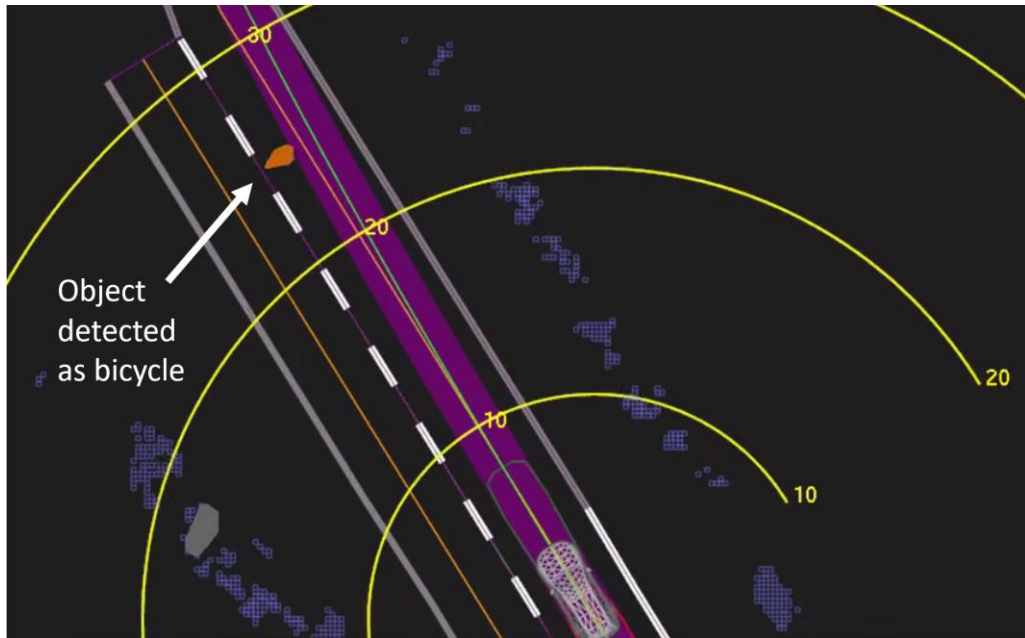
Kuva 4. Uberin tutkien havainnointi 1.3 sekuntia ennen törmäystä (NTSB 2018)
