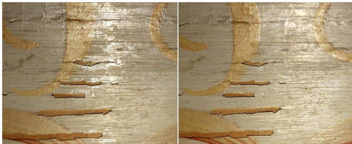
Kuva 38. Akryylidispersio aiheuttaman kiillon poisto (Piekäinen 2019)
