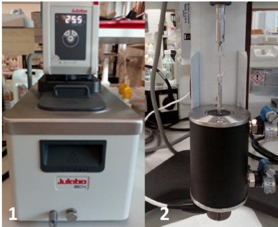
KUVA 7. 1. Vesihaude kierrätävän veden lämpötilan säädöllä 2. Piennäyteadapteri liitettyä viskosimetriin (Mäkinen, 2017)
