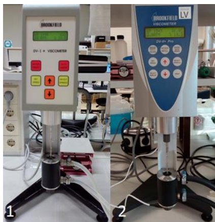
KUVA 2. 1. RV-viskosimetri 2. LV-viskosimetri. Viskosimetreihin on liitetty piennäyteadapterit, vesikierto sekä lämpötilaa mittaavat anturit (Mäkinen, 2017)
