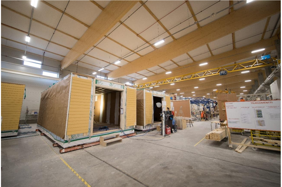
Kuva 5. Lehto Componentsin Oulaisten tehdas. Rakenteilla puukerrostalomoduleita.
