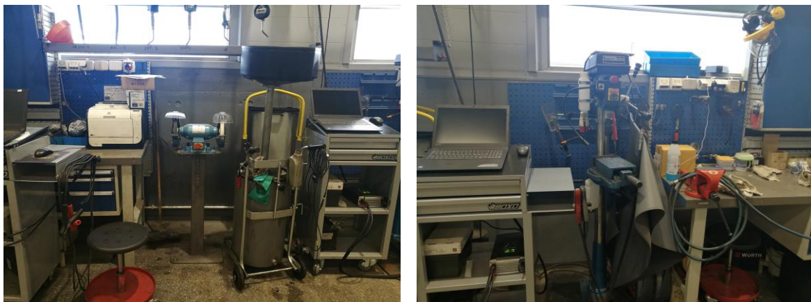
Figur 15. Verkstaden skulle bli en trivsammare och säkrare arbetsplats genom att flytta maskiner som slipstenar och pelarborrmaskiner till ett skilt heta arbeten område
