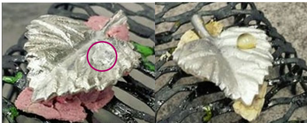
Kuva 23. Ennen ja jälkeen kuvat punaisella merkityn lasikappaleen kiinnitysprosessista Koivunlehti -riipukseen. Menetelmänä oli lasin sulattaminen suoraan kiinni metalliin.
