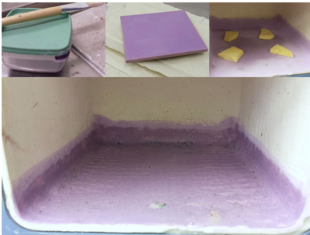
Kuva 17. Uuninsuoja-aineella käsitely emaliuunin sisus, sekä keraaminen pohjalevy ennen sulatusohjelman läpikäymistä. Väri muuttui valkoiseksi, ensimmäisen polton jälkeen.
