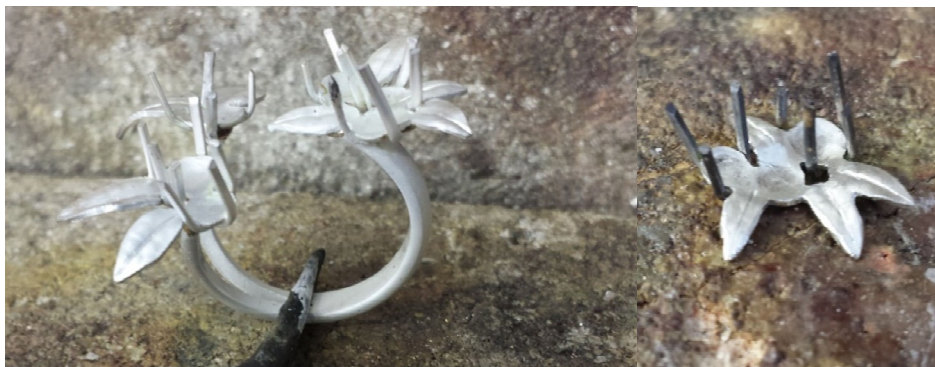
Kuva 45. Karpalo -koruihin langasta tehtyjä istukoita, juotettuna sormusrunkoon.
