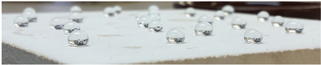
Kuva 33. Ensimmäisten lasinsulatuskokeilujen tuloksena syntyneet kirkaat lasipisarat.
