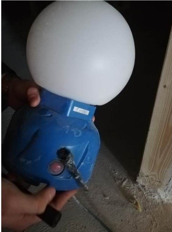
Kuva 30 Valaisimen sähköjohto rikki (Mikael Saja)
