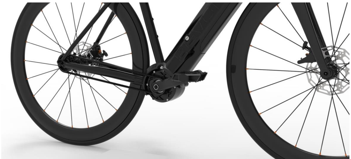
KUVA 11. Moottori osana pyörän muuta rakennetta.
