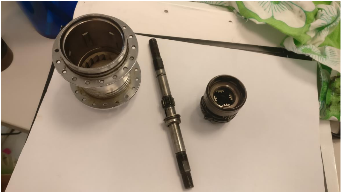
KUVA 17. Shimanon kolmivaihteinen napavaihte
