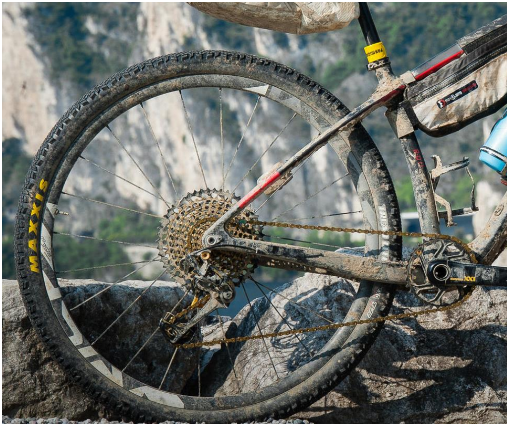
KUVA 2. Polkupyörän ketjuvaihteisto (Sram LLC 2016)
