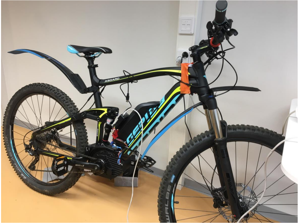
KUVA 12. Datan keräykseen käytetty testipyörä. Akun päällä näkyvissä Raspberry Pi mikrotietokone ja Raspberrystä moottorin sisään kulkevat johdot. (Palonen, 2019)
