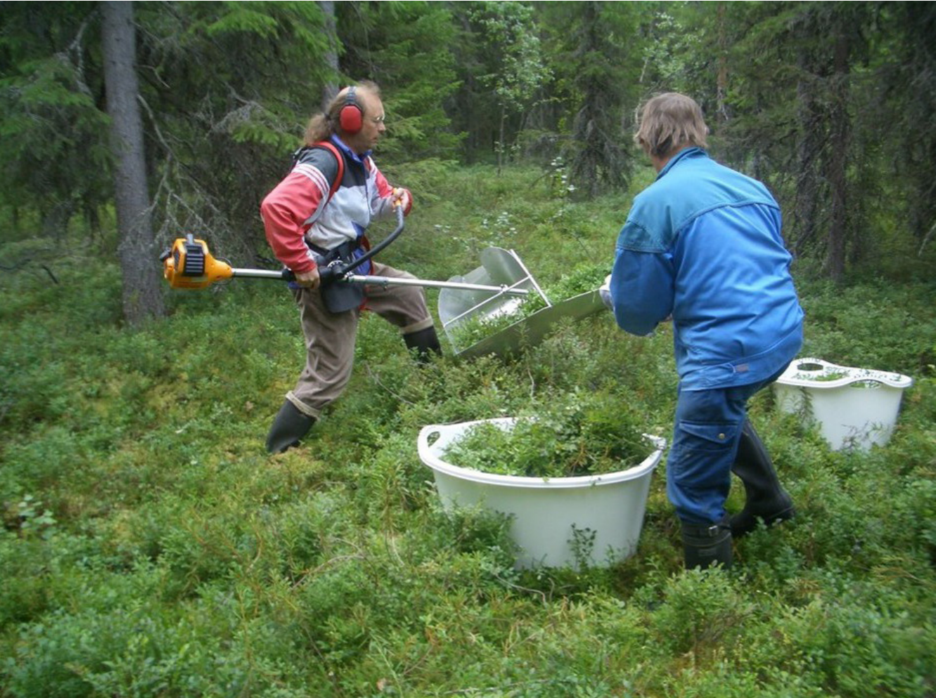
Kuva 5. Suurempien määrien talteenotto edellyttää laitteita. Kuvassa mustikanversojen leikkuuseen soveltuva pensasleikkuri ja siihen kehitetty leikkuupää. Toimintaan vaaditaan maanomistajan lupa. Kuva: Markku Koistinen
