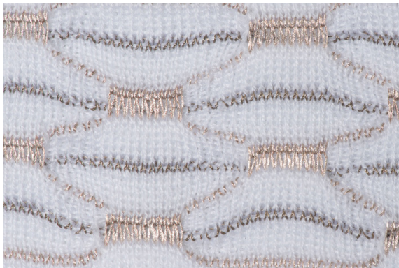
Kuva 19. Neulekangas, johon on neulottu kuvioita sähköä johtavilla langoilla.
