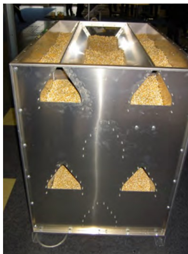
KUVA 6. Kuivauskennon rakenne.( Hautala ym. 2013, 79)
