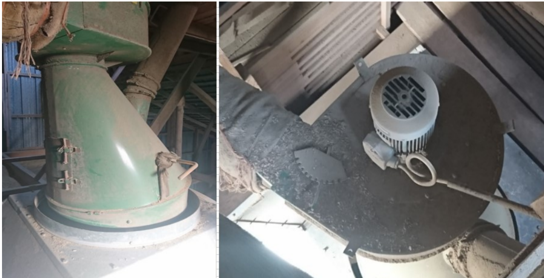
KUVA 5. Esipuhdistin kuvattuna sivulta ja ylhäältä.
