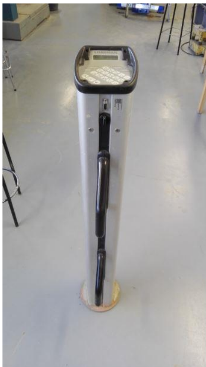
KUVA 5.4. Kantavuusmittauksissa käytetty kevytpudotuspainolaite Loadman II (Tuunainen 2019-04-17)
