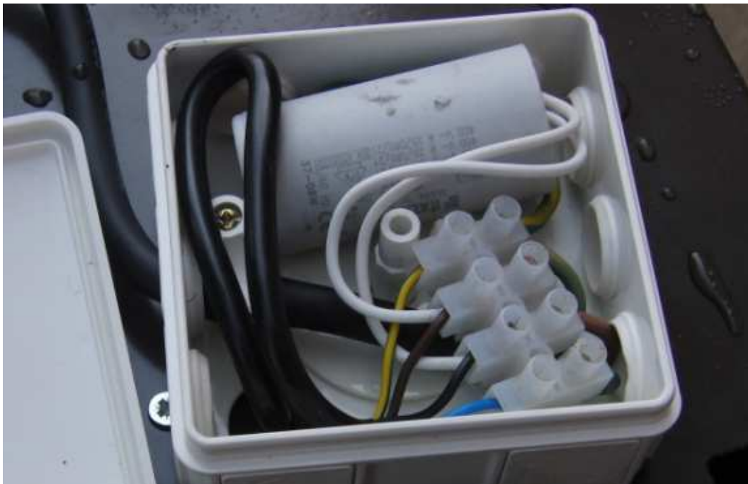
Kuva 14. Kytkentärasia suojausluokkatestin jälkeen
