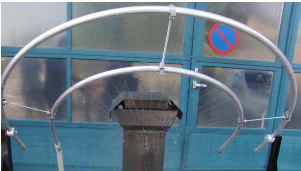
Kuva 12. Huippuimurin suojausluokan selvittäminen
