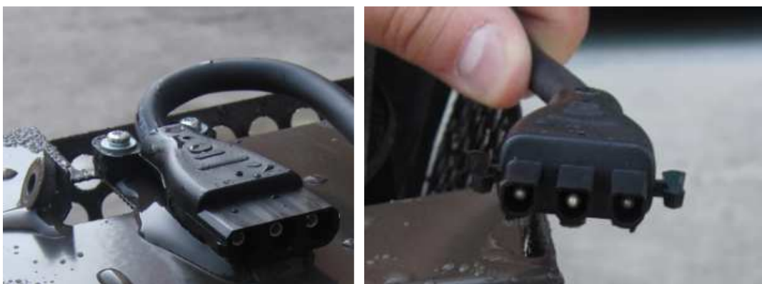
Kuva 13. Pistoke suojausluokkatestin jälkeen
