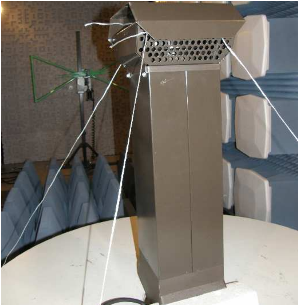
Kuva 15. Säteilevien häiriöiden mittausolosuhteet
