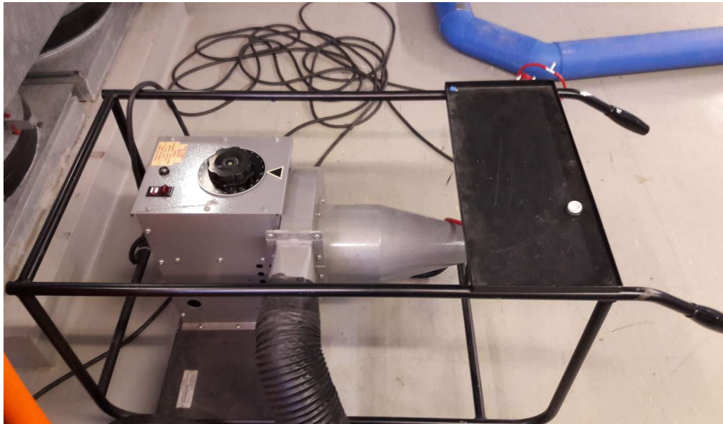
Kuva 10. Mittauksissa käytetty koepainepuhallin.
