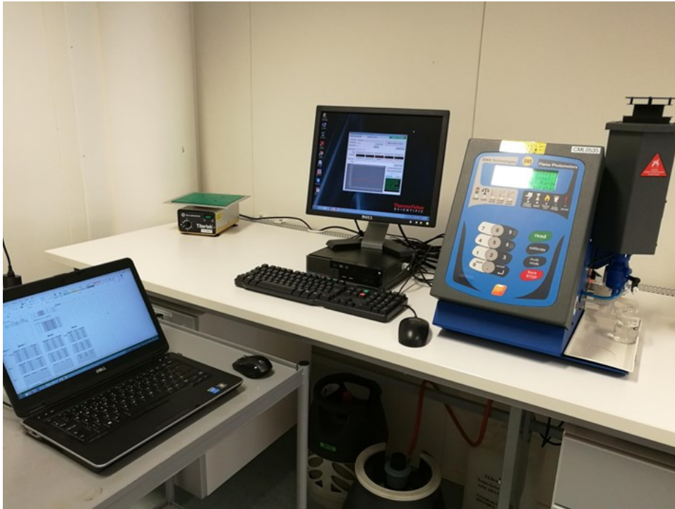
Kuva 10. Liekkifotometri ja sen tietokone, sekä kannettavaan tietokoneeseen avattu laskentapohja.
