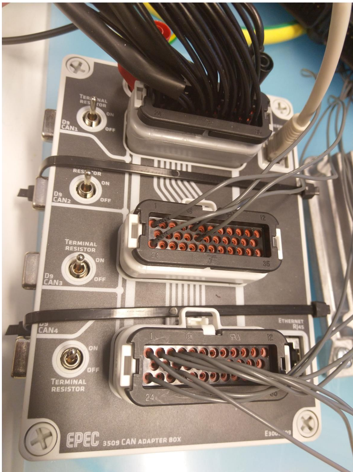
KUVA 30. CAN-adapterin AMP 35 -liittynät (Reko 2019)
