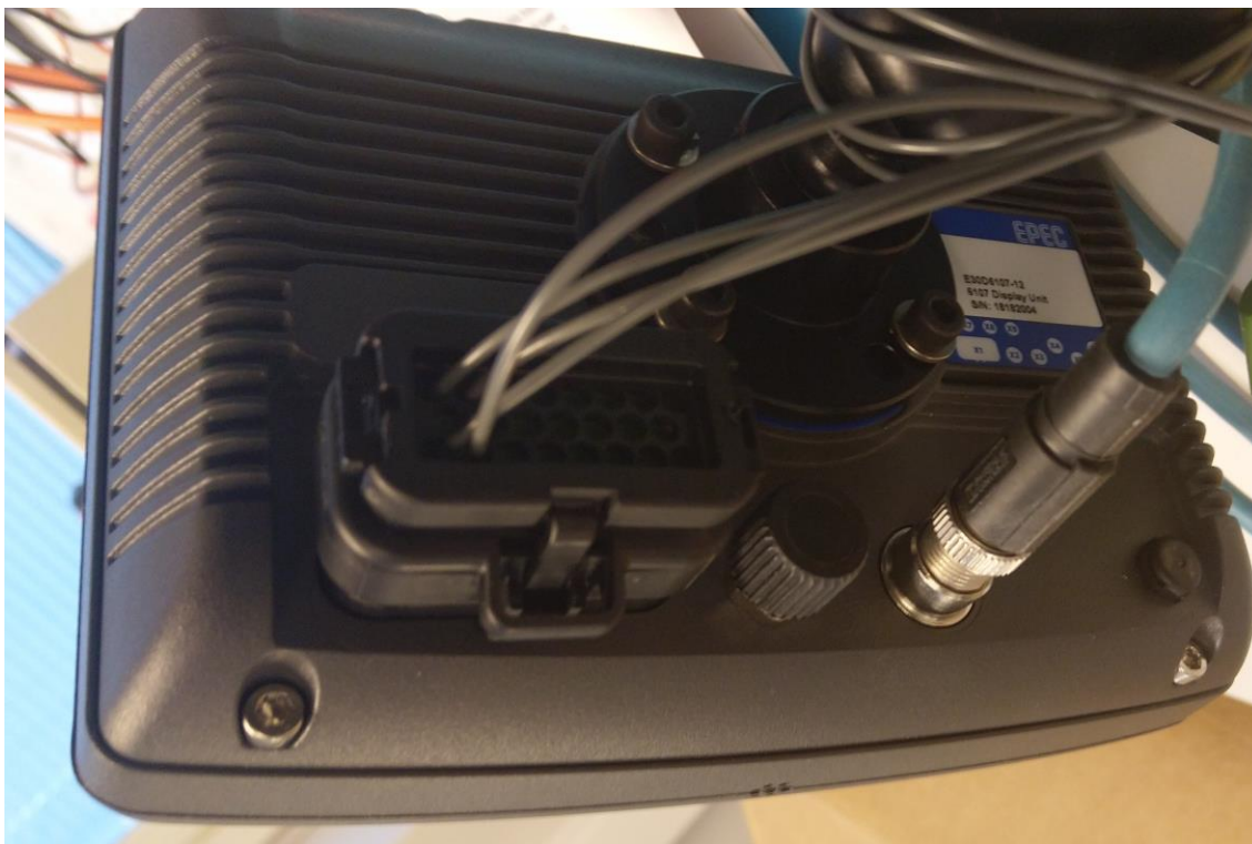
KUVA 32. Kosketusnäytön liitynnät AMP 23 ja M12 -liittimillä (Reko 2019)
