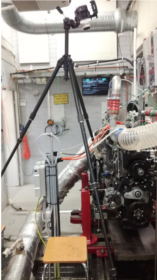
KUVA 27. Suurnopeuskamerakuvaus ahtimelle. (Kiiskilä, 2019)
