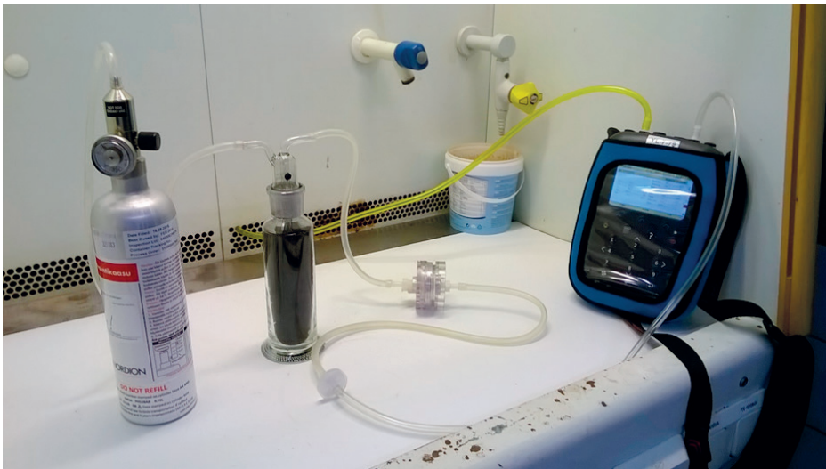
KUVA 1. Laboratoriokokeissa suodatusyksikkö koottiin kaasujenpesupulloon (Kuva: Niina Laurila)
