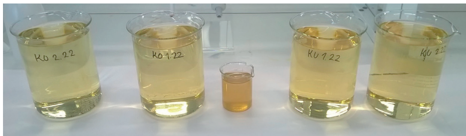
KUVA 3. Kuvassa vasemmalla koivuhiilisuodokset ja oikealla kuusihiilisuodokset. Keskellä on jäteaseman suotovettä (Kuva: Niina Laurila)
