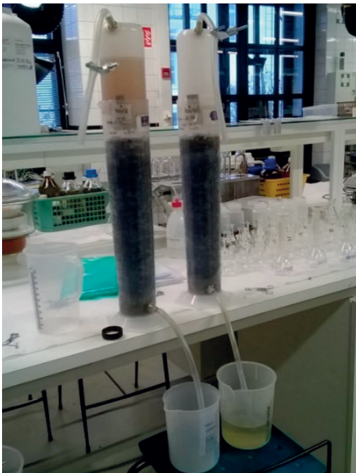
KUVA 1. Sepeli-biohiili-sepeli suodatinkolonnit (Kuva: Niina Laurila)
