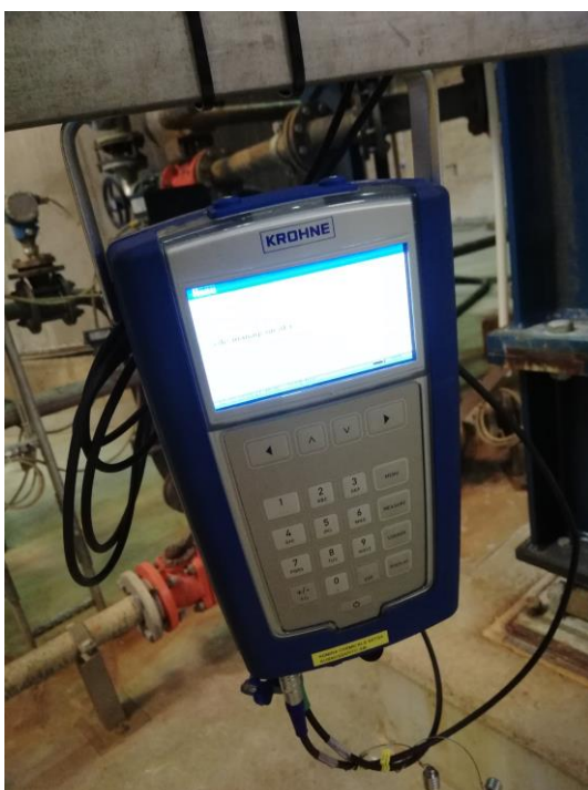
KUVA 7. Virtausmittari keräämässä virtauksien dataa.
