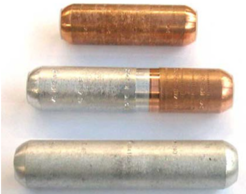
Kuva 14. Kolme puristettavaa liittintä erilaisille johtimille. Ylin on tarkoitettu kuparijohtimien liittämiseen, keskimmäinen soveltuu alumiini- ja kuparijohtimien liittämiseen ja alin käy alumiinijohtimien liittämiseen [24, s. 2].
