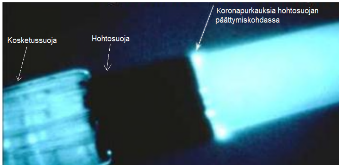
Kuva 8. Koronapurkauksia hohtosuojan päättymiskohdassa [muokattu lähteestä 20, s. 843].
