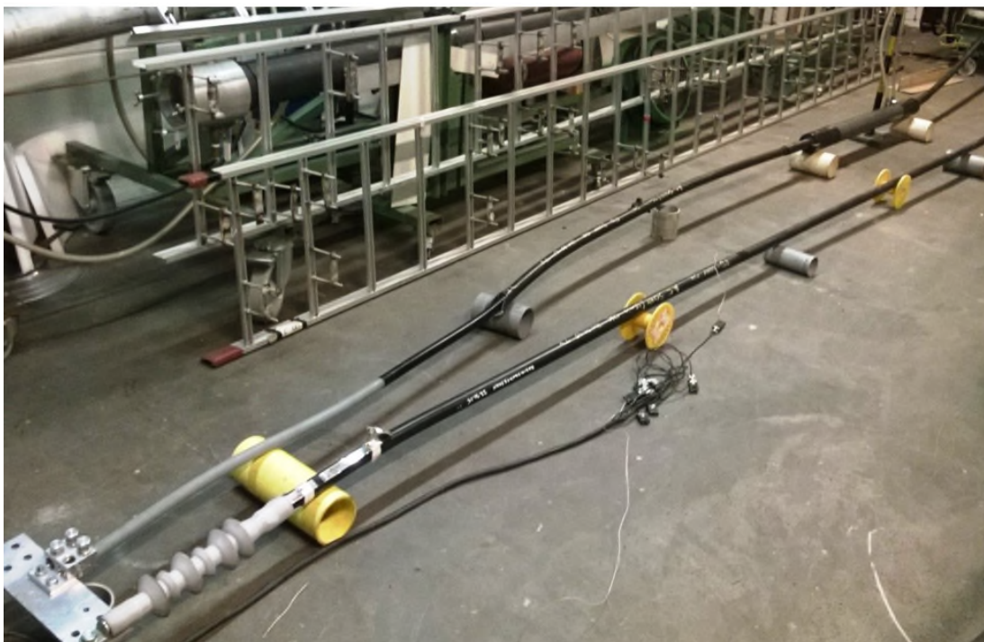
Kuva 32. Pitkäaikaiskokeen koekappaleet 1A ja 1B kuormituskokeessa joulukuussa 2015. Vesi- tiivyeyskokeen asennus jatkoksessa näkyy kuvassa taka-alalla [31].
