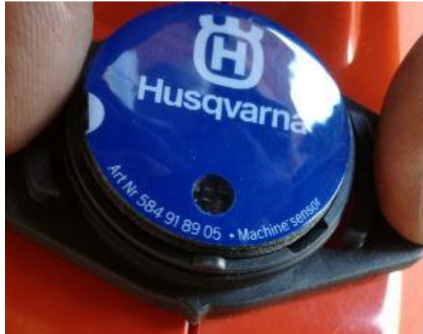
Kuva 3. Husqvarna koneeseen asennettava anturi (Miettinen 2018)
