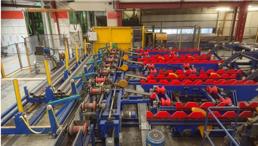
Kuva 19. Putkien siirto laitteisto ja putken päiden hionta (Walkingbeam)
