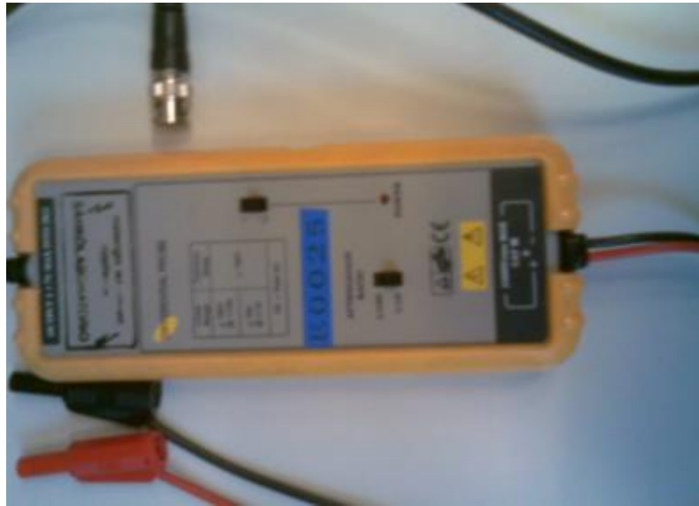
Kuva 17. Mittauksissa käytetty galvaaninen erotin
