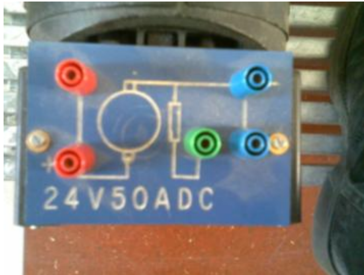
Kuva 8. Voimakoneena toimivan tasasähkökoneen sisäinen kytkentä
