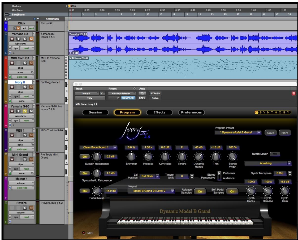
Kuvio 36. Kuvassa Yamaha B3 Silent- pianolla soitettu "Valssi". Ylimpänä aaltomuoto, alempana MIDI- tiedosto. Tällä voidaan ohjata mitä tahansa MIDI -soitinta, kuvassa Ivory- laajennus (plugin).
