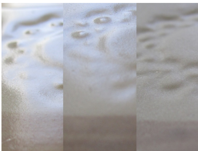
Kuva 9. Lasitteen kiilto: kiiltävä, semimatta ja matta
