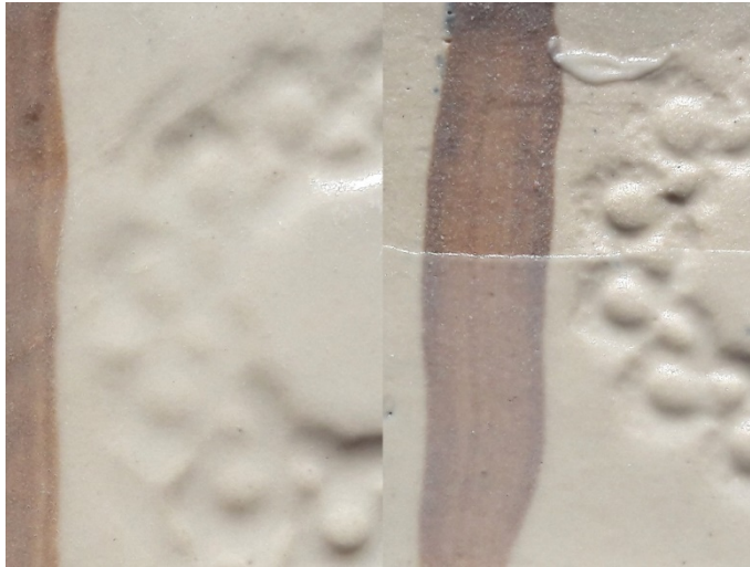
Kuva 12. Lasitteen sulavuus: sulanut ja sulamaton
