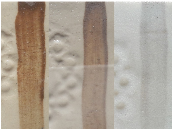
Kuva 10. Lasitteen läpinäkyvyys: läpinäkyvä, himmeä ja opaali
