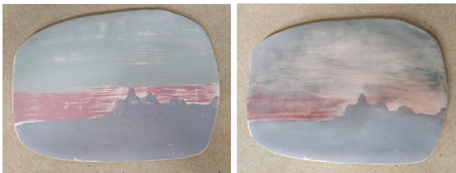
Kuva 31. Vasemmalla koepala patinan siveilyn jälkeen ja oikealla kuva koepalasta, jossa patina on pyyhitty kostealla sienellä.
