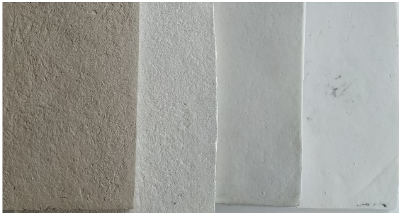
Kuva 6. Mallikuva savien värien sävyistä polton jälkeen. Savet vasemmalta oikealle; kivitavarasavi WM2505, samotillinen puoliposliini 1112, samotiton puoliposliini 1100 ja posliini ES170.
