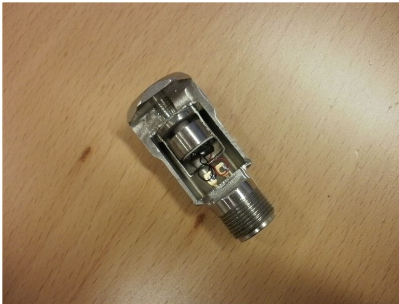
Kuva 12. Pystymallinen pietsosähköinen kiihtyvyyssanturi avattuna
