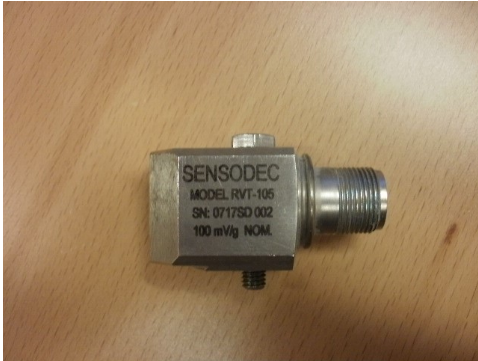
Kuva 13. Vaakamallinen pietsosähköinen kiihtyvyyssanturi
