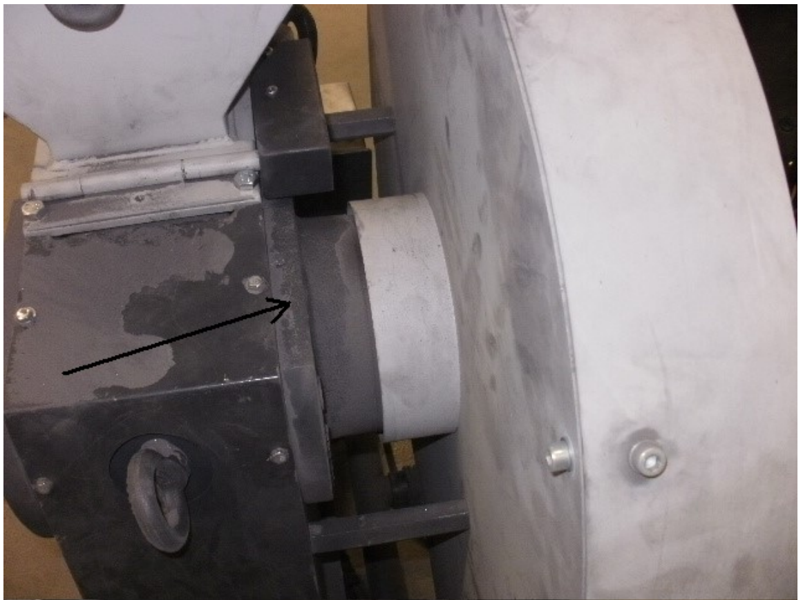
Kuva 18. Vauhtipyörän akselin vasemmanpuoleinen laakeri murskaimen takaa kuvattuna. Sopiva asennuspaikka on merkitty nuolella. Oikealla valkoinen vauhtipyörän suojaletti. [10.]
