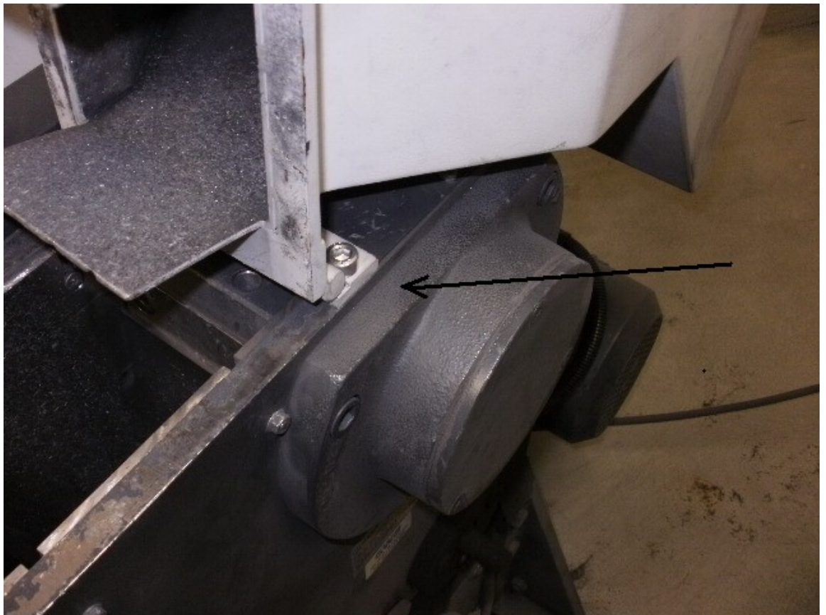
Kuva 17. Vauhtipyörän akselin oikeanpuoleinen laakeri murskaimen edestä kuvattuna. Sopiva asennuspaikka on merkitty nuolella. Valkoinen syöttökaukalo on ylös nostettuna. Vasemmalla näkyy musta murskaimen kita. [10.]
