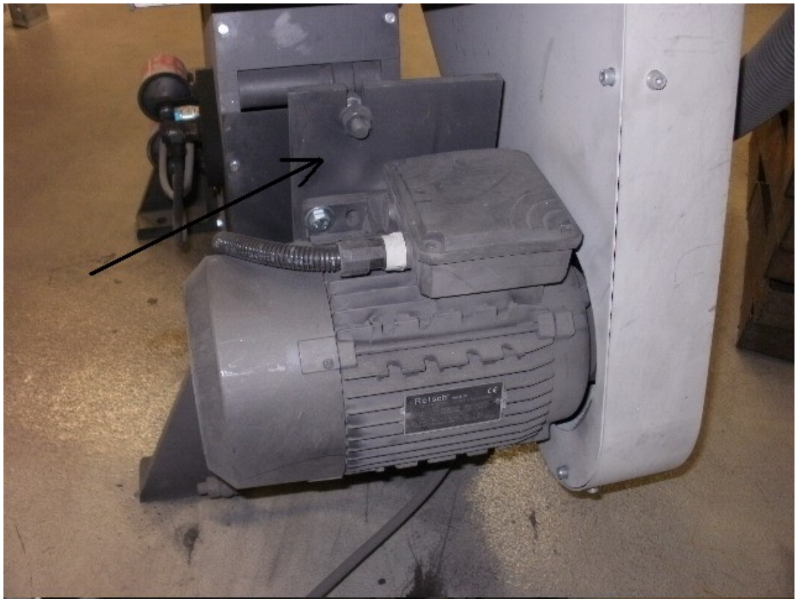
Kuva 20. Murskaimen sähkömoottori takaa kuvattuna. Sopiva asennuspaikka on merkitty nuolella. Oikealla valkoinen hihnapyörän suoja-pelti. [10.]
