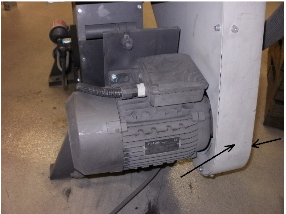
Kuva 21. Oikealla valkoinen hihnapyörän suojaipelti. Sopivat asennuspaikat induktiiviselle anturille on merkitty nuolella. [10.]
