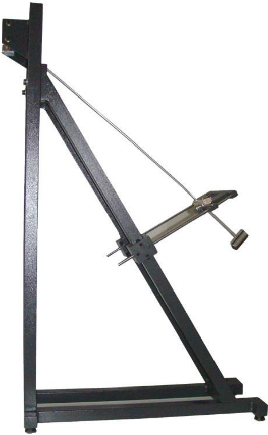
KUVA 6. Jousivasaratestillä testataan tuotteen mekaaninen lujuus (Seguridad electrica).
