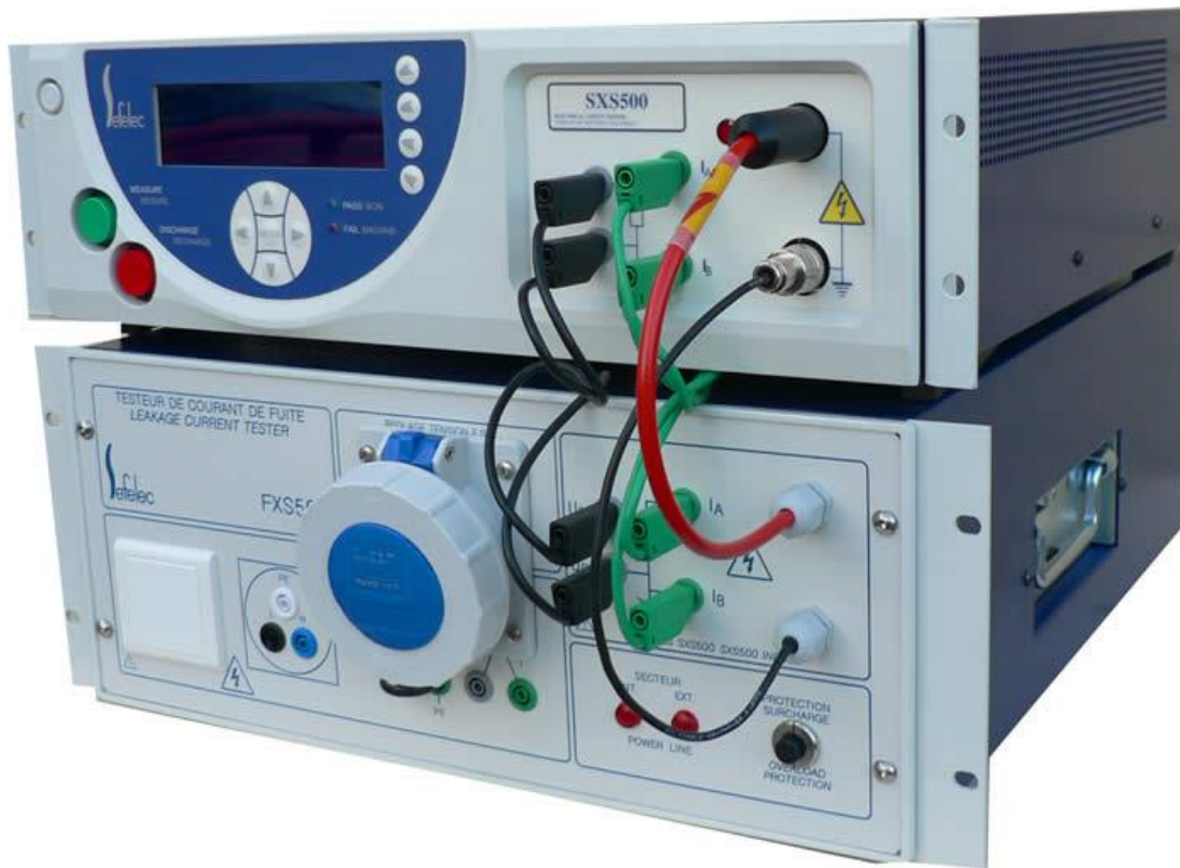
KUVA 8. Sefelec SXS500 sähköturvallisuustesteri (Sefelec).
