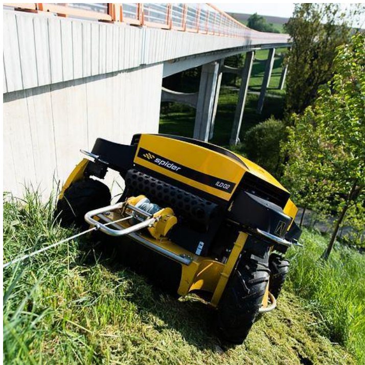
Kuva 13. Spider ILD02 -leikkuri niittämässä rinnettä (Slope-mover 2019)
