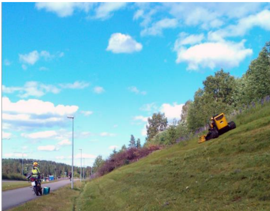
Kuva 12. Niittorobotti työssä (Liikennevirasto 2014, 103)
