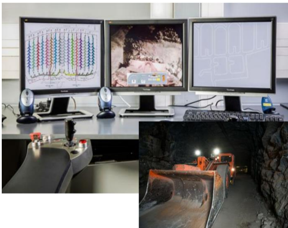
Kuva 14. Sandvikin AutoMine-teleoperointiasema ja itsenäinen lastari (LHD) (Ventä ym. 2016, 17)
