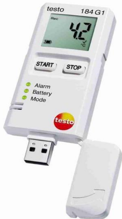
Kuva 18 Testo 184 G1- loggeri (Testo-ohjekirja 2018)
