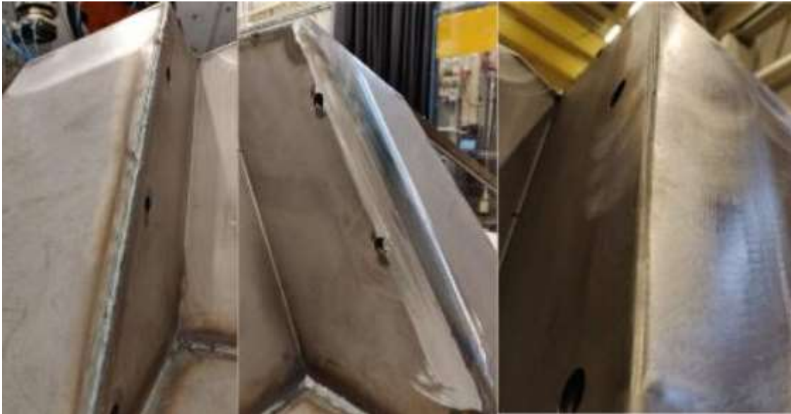
KUVA 17. Kappaleen sauma ennen hiontaa, kulmahiomakoneen jälkeen ja hiomakoneen jälkeen (34)
