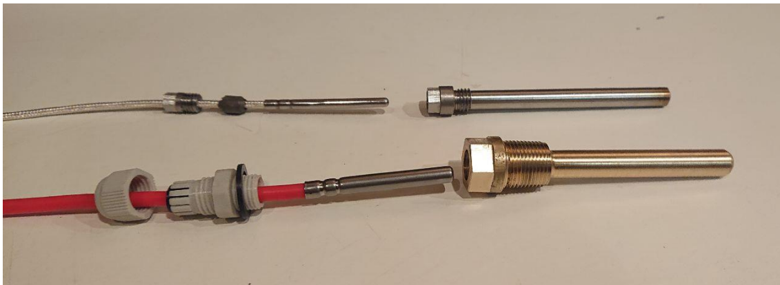
KUVA 7. Lämpötila-anturit ja niiden suojaputket
