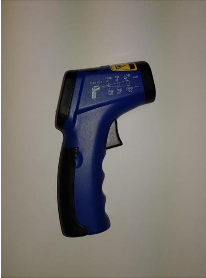
Kuva 10. Velleman DM100 Laserlämpömittari. Mitta-asteikko -50 C +/- 330 C.
