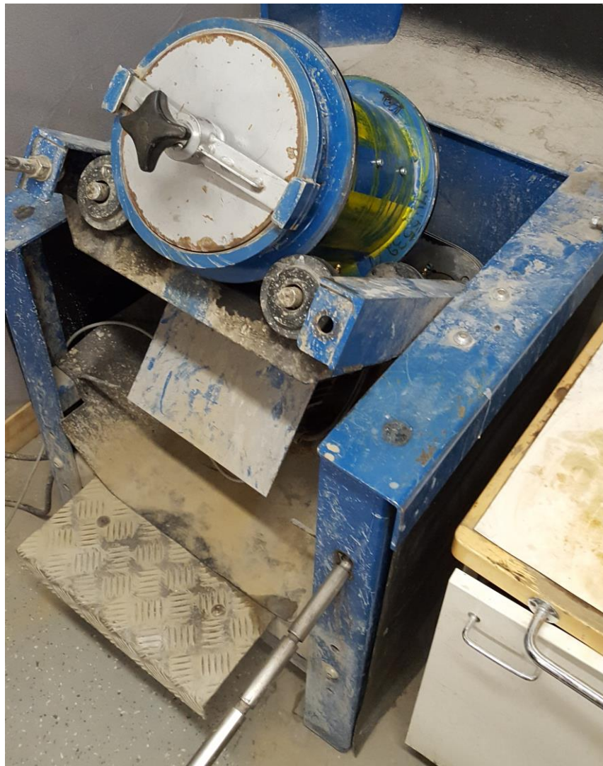
KUVA 5. Kuulamyly nostettuna täyttöasentoon kannen ollessa kiinni
