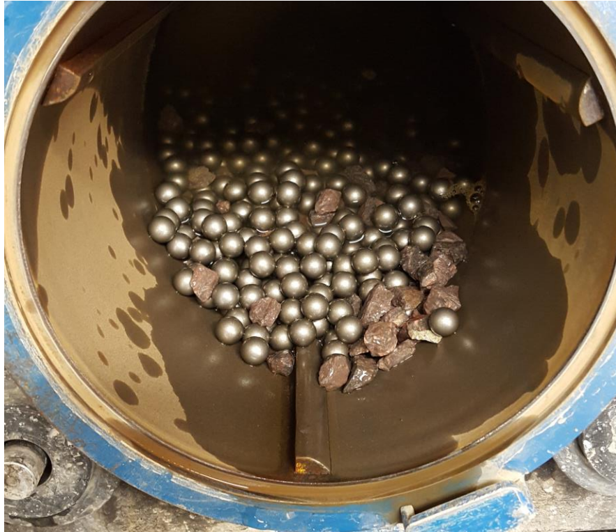
KUVA 13. Näytteen 1 yksittäistestinäyte II valmiina kuulamylytettiin
