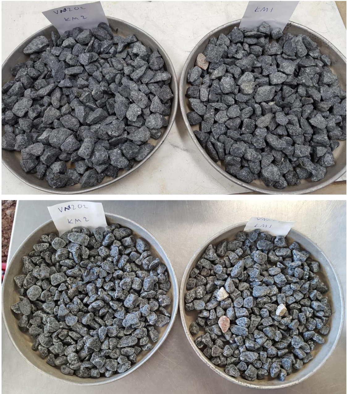
KUVA 14. Näyte 2 ennen ja jälkeen kuulamylytestin, yksittäistestinäytteet merkattu KM1 ja KM2
