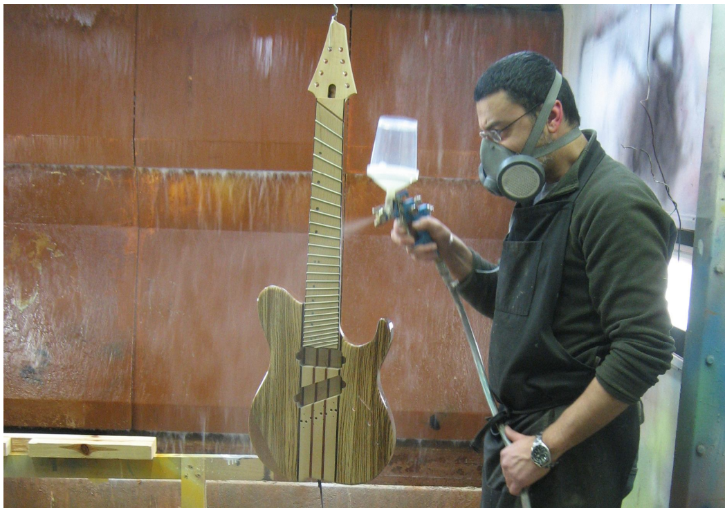
Kuva 49. Carlozzo ruiskuttamassa ensimmäisiä kerroksia polyuretaani-lakkaa.
