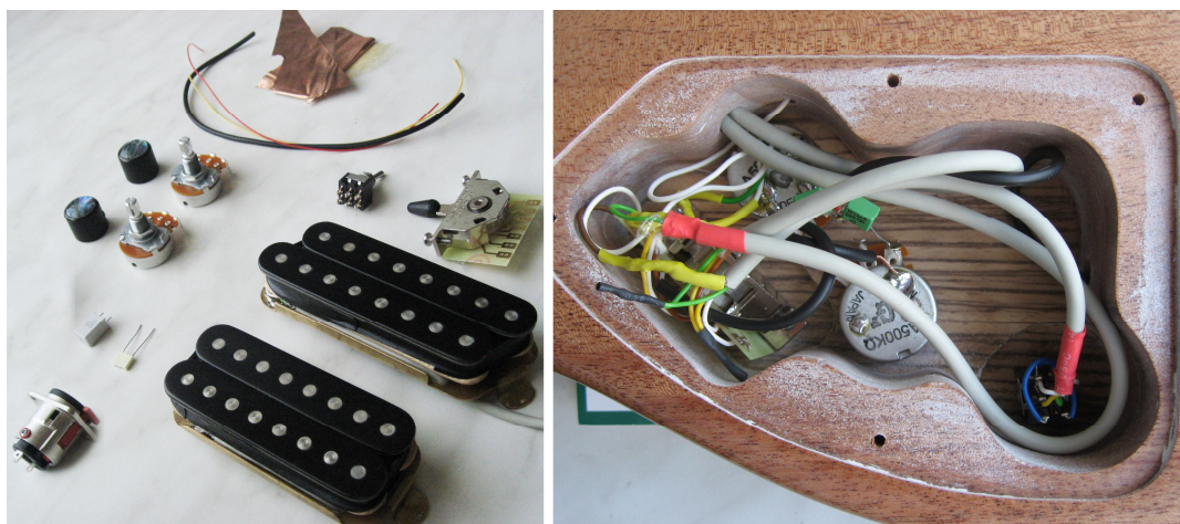
Kuva 63. Kitaran sähköosat ennen ja jälkeen kytkentöjen.
