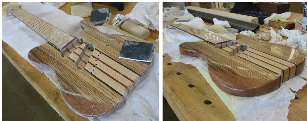
Kuva 50. Lakkapinnan vesihionta ja lopuksi kiillotettu lakkapinta.
