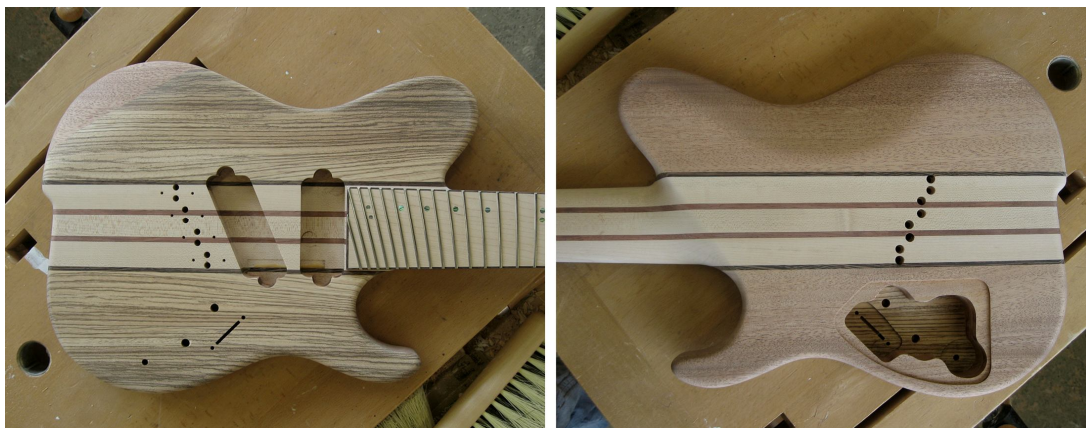
Kuva 47. Rungon jyrsinnyt ja tallojen vaatimat reiät.
