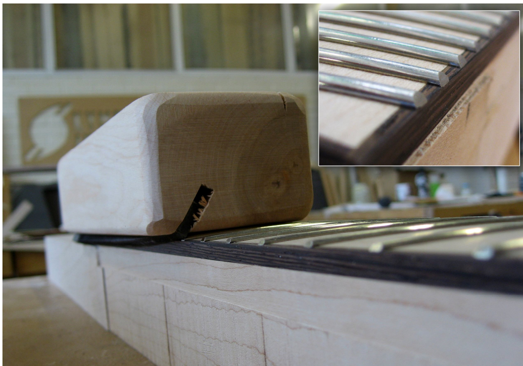
Kuva 32. Nauhojen päiden hionta 45 asteen kulmaan.
