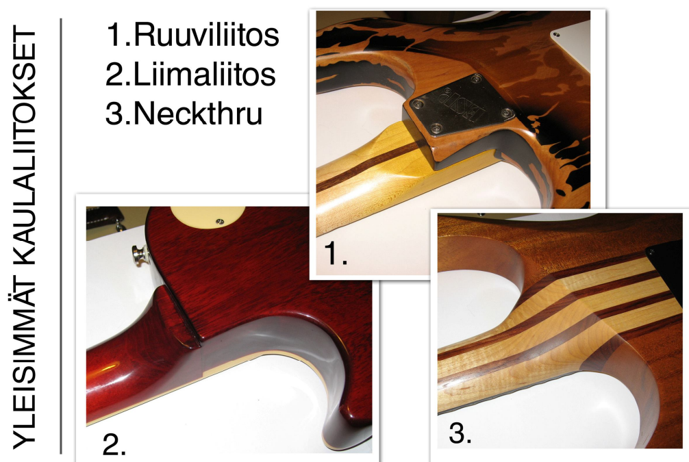
Kuva 9. ESP-kitaran ruuviliitos, Lespaul-kitaran liimaliitos sekä Sinn -kitaran läpikaula –rakenne.
