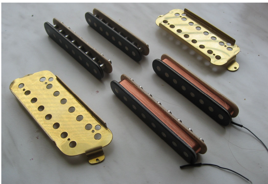
Kuva 59. 2kpl valmiita keloja ja 2kpl kellarunkoja sekä messinkiset mikrofonipohjat.
