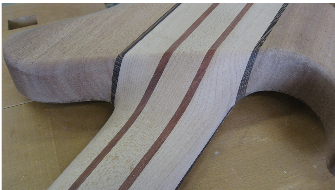
Kuva 46. Ergonomisesti muotoiltu ja viimeistelty kaulan kanta.
