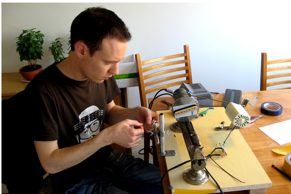
Kuva 58. Mikrofonin kelan käämintä.
