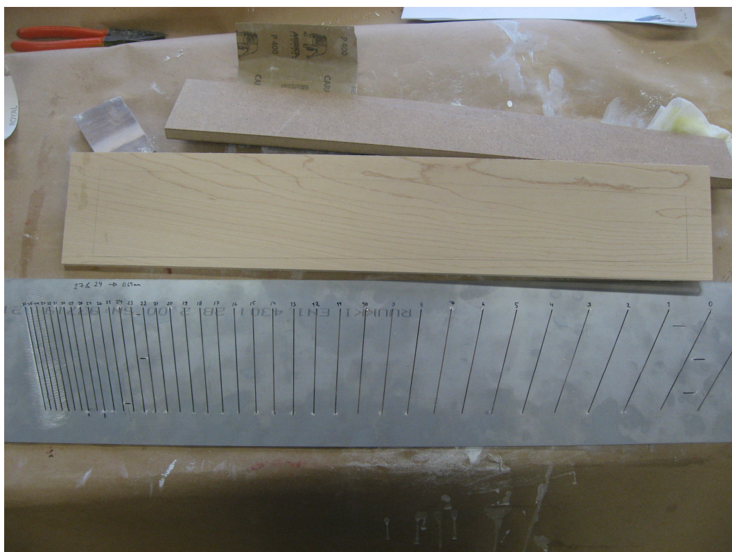
Kuva 23. Otelautasabluuna, vaahteralankku otelauta-aihioksi sekä sahausjigi.
