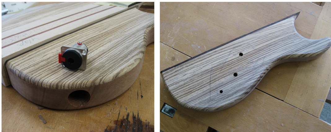
Kuva 44. Jakin, potentiometriin ja phase-kytkimen reiät.
