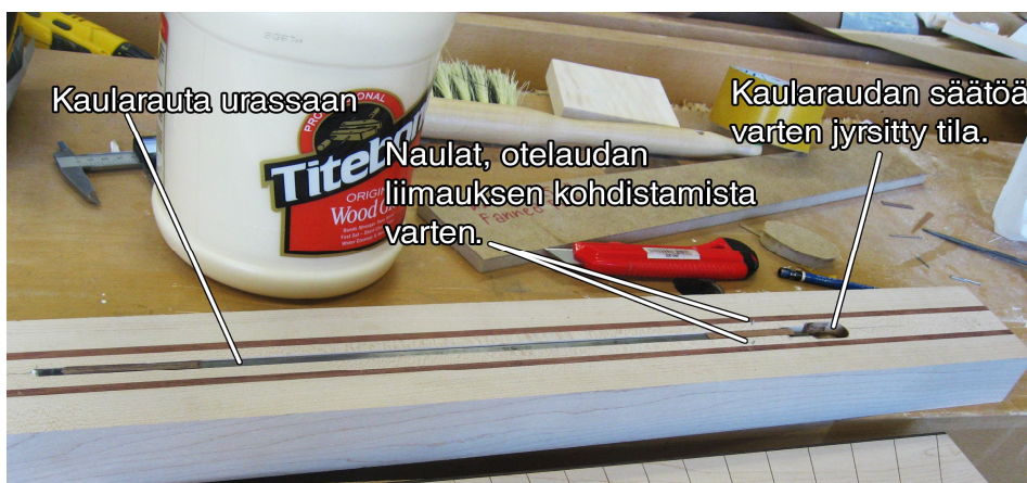
Kuva 27. Kaularaudan asennus kaulapakkaan sekä otelaudan liimauksen valmistelut.
