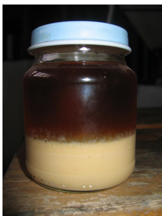
KUVIO 18. Vesipesun jälkeen pesuvesi erottunut pohjalle ja biodiesel pinnalle
