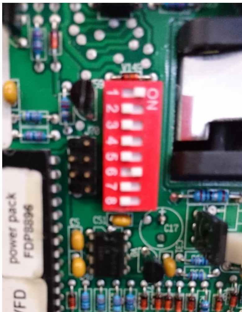
Kuva 21. Invertterin asetukset DIP-kytkimillä määriteltynä.
