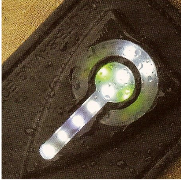
Kuva 5: Paloasuissa oleva hohtodiodeilla varustettu varoitusjärjestelmä. /3/
