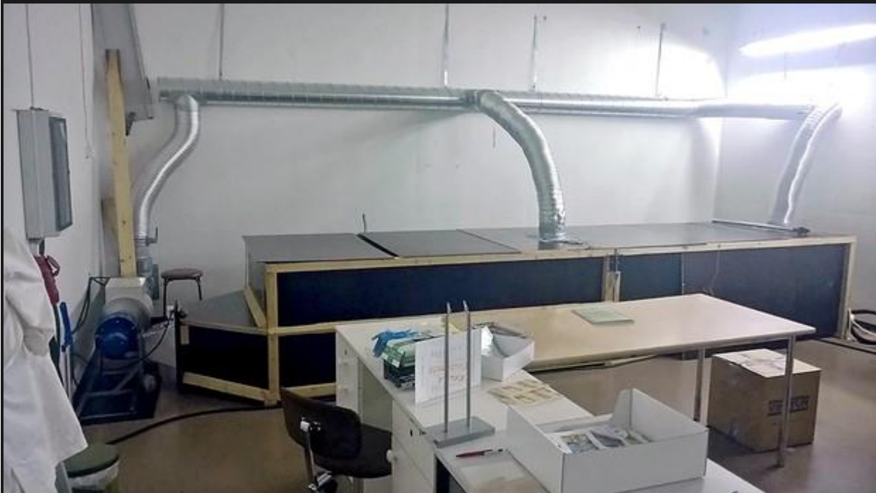
Pentin Määttän kuivuri on kaksilohkoinen (kaksi osastoa peräkkäin), yksitasoinen lavakuivuri. Kasvimassa asetetaan suomulevytasolle, lämmitetty ilma puhalletaan suomulevyn alapuoliseen osaan. Ilma virtaa kasvimassan läpi ylös, ja poistuu kansien raosta huonetilaan tai otetaan kierrätykseen.
