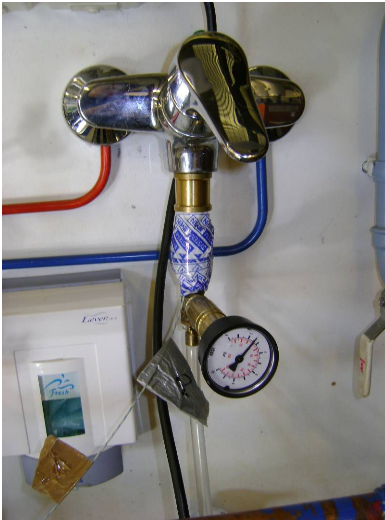
KUVA 8. Sekoittaja, painemittari ja lämpötila-anturi
