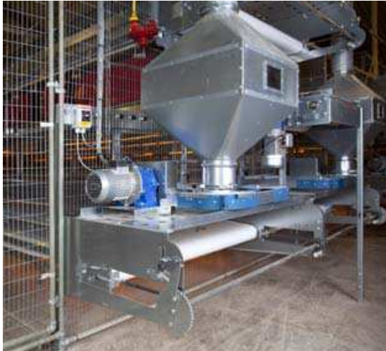
Kuva7. Rehun jakojärjestelmä ketjuruokkialle. /10/
