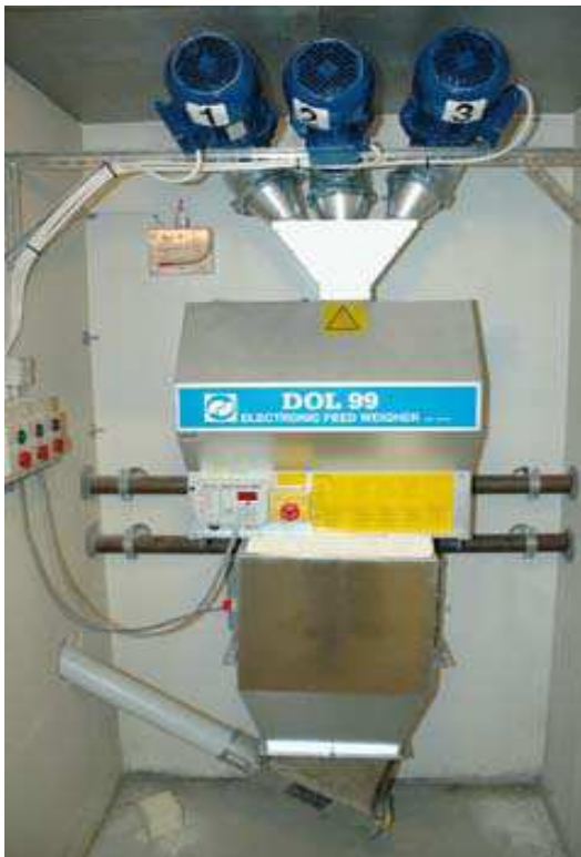
Kuva 8. Dol 99 rehu vaaka – järjestelmä. /9/
