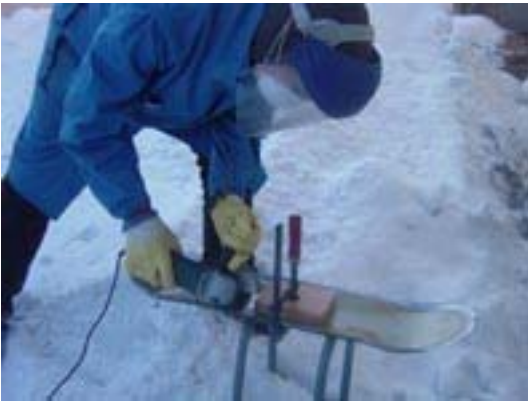
Laminoinnin jälkeen lopullinen muoto leikattiin ja hiottiin kulmahiomakoneella. Tämän jälkeen lauta siveltiin vielä kertaalleen ympäriinsä hartsilla, reunat erityisesti.
