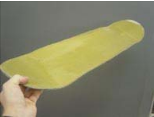
Valmis lauta. Laudan pinta ja pohja on kulutusta ja iskuja kestävä kevlaria ja välimateriaalina kevyttä hiilikuitua. Epoksihartsia muodostaa siis matriisin, jossa em. kuidut toimivat lujitteena.
