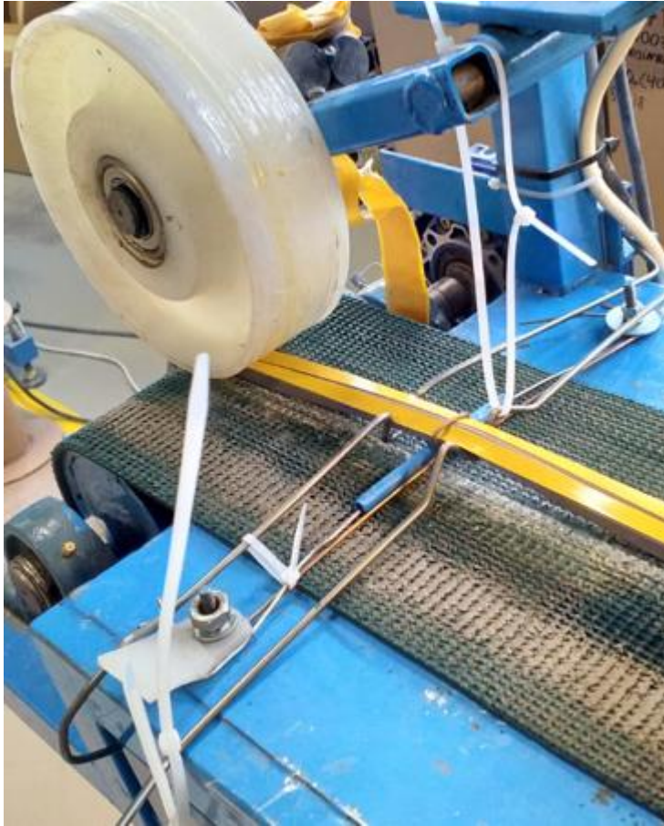
KUVA 4. Esimerkki vaikean profiilin vaatimista lisäohjaimista
