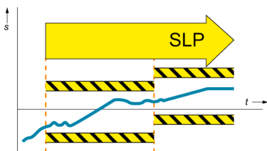
Figur 7. SLP-funktionens funktionsprincip angiven som funktionen av positionen s och tiden t vid aktivering av funktionen med olika positionsgränser (orangefärgade streckade linjerna). (Siemens AG)
