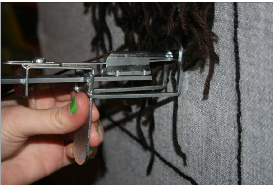
KUVA 20. Tuftauslaitteen pitäminen pystysuorassa kohti kangasta.
