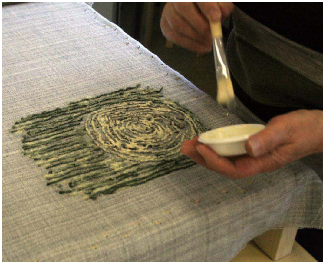
KUVA 28. Työn tausta liimataan maitoliimalla tai erityisellä tuftausliimalla, jotta langanpäät eivät purkautuisi.
