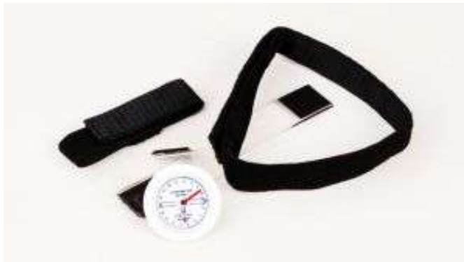
KUVA 10. Myrin-kulmamittari (Lojer Oy).
