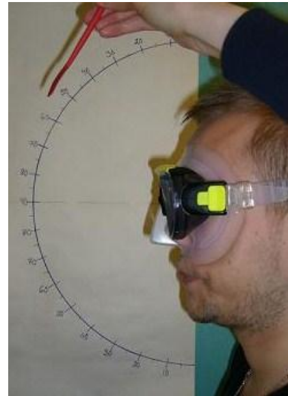
KUVIO 9. Vertikaalisen näkökentän mittaus pinnalla.
