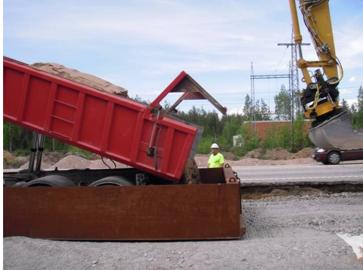
Kuva 21 "Hiekkalaatikon" täyttö ja tyhjennys
