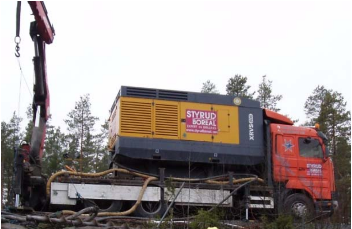
Kuva 26: Vaakaporausvoiman lähde ja koneikko
