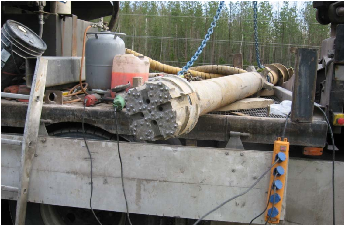
Kuva 22: Porausjärki ja poratanko
